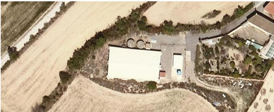
Figura 9. Depósito de planta rectangular de 1.000 m<sup>3</sup> y depósitos de 100 m<sup>3</sup> circulares.
