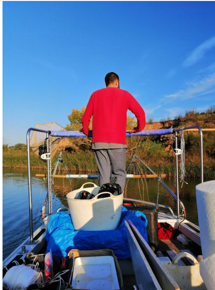
Figura 10. Equipo de electropesca desde embarcación preparado para el muestreo en el embalse de Flix
