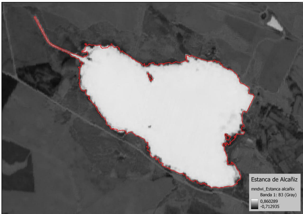
Figura 3. Índice NDWI aplicado a la imagen de satélite para identificar la lámina de agua
