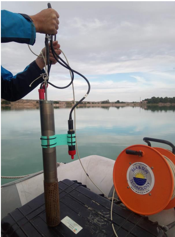
Figura 1. Técnicos realizando perfil físico químico en el embalse de La Estanca
