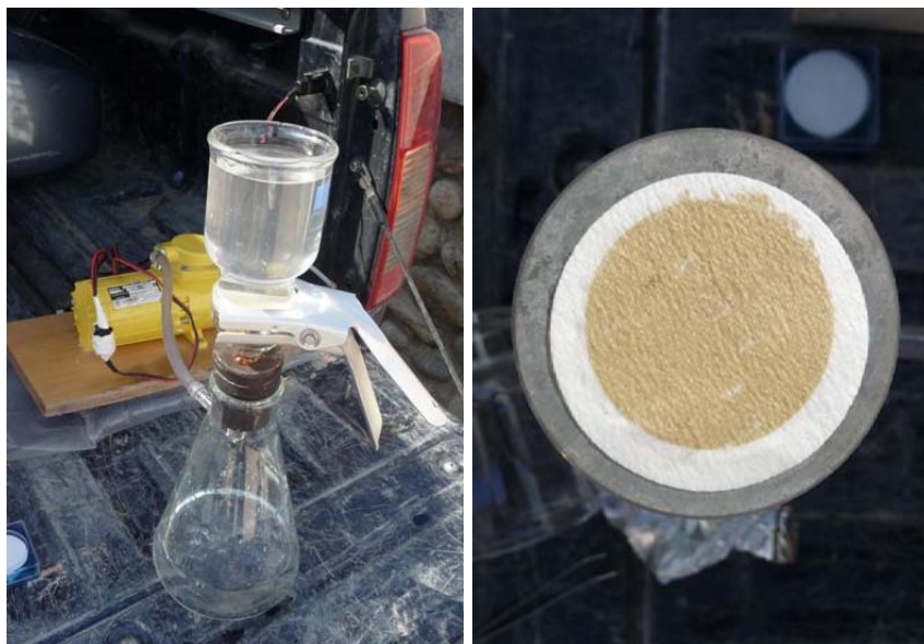
Recogida de muestras para análisis de clorofila.
