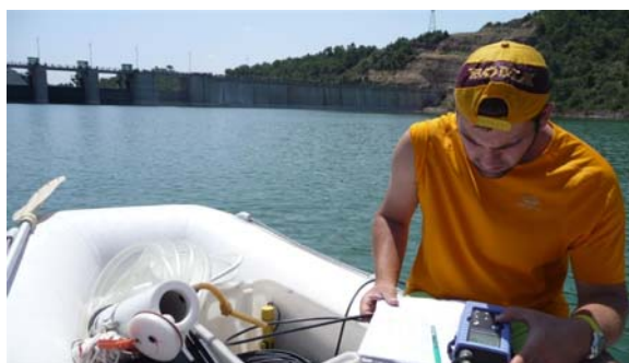
Toma de datos fisicoquímicos in situ mediante sonda multiparamétrica. Embalse de Rialb, 16/07/2009.
