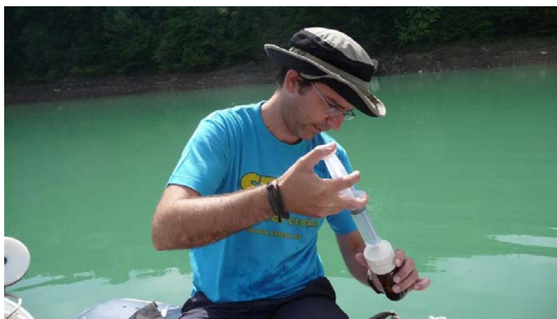
Toma de muestras de agua y filtración a bordo para análisis de SRP y otros parámetros químicos. Embalse de Irabia, 18/06/2009.
