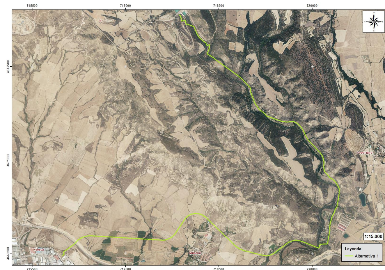
Figura. 5. Trazado de la tubería, alternativa 1
