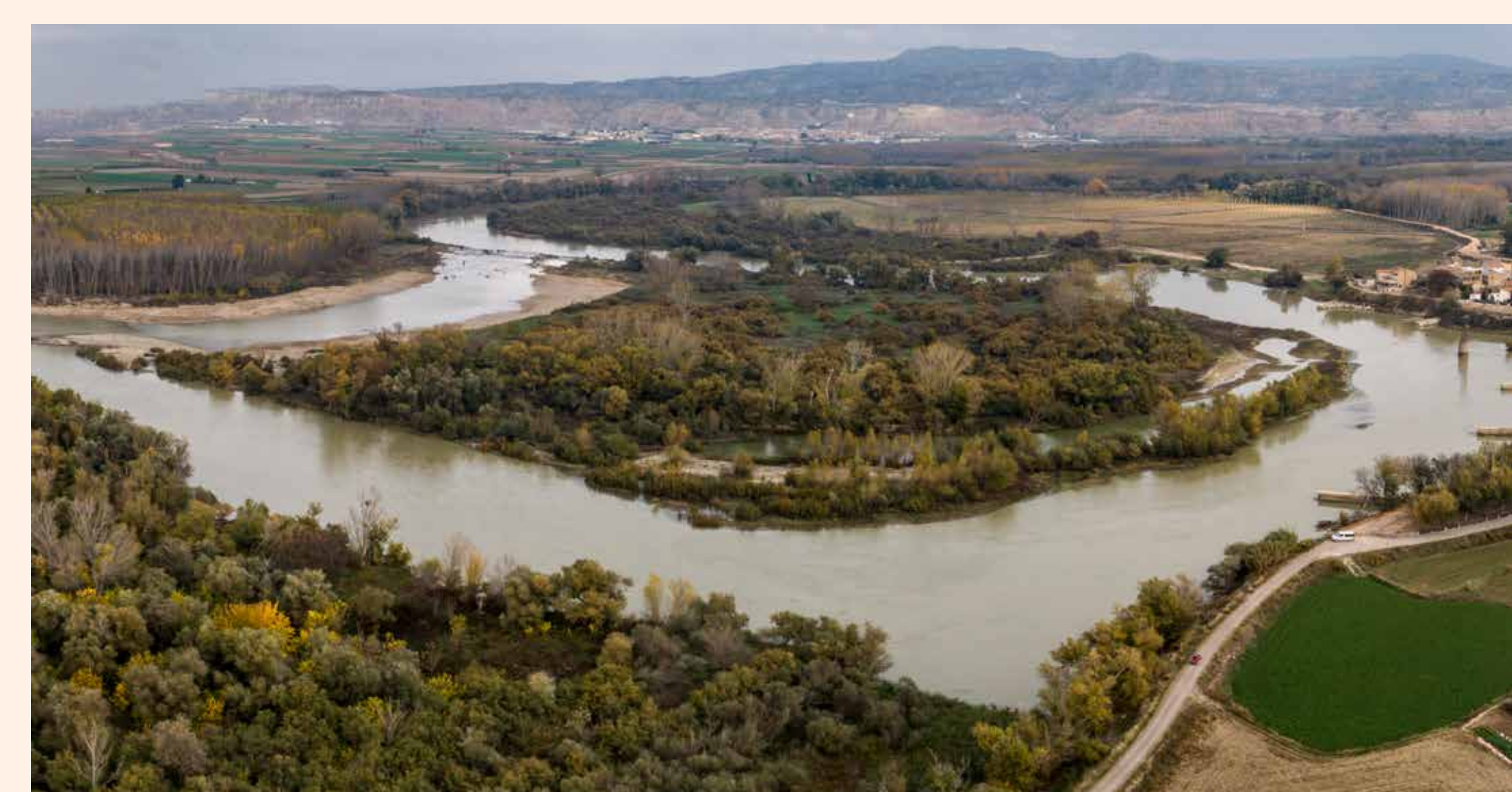
Cauce de alivio, o cauce que entra en funcionamiento en crecidas para minimizar daños, en Alcalá de Ebro (Zaragoza)
