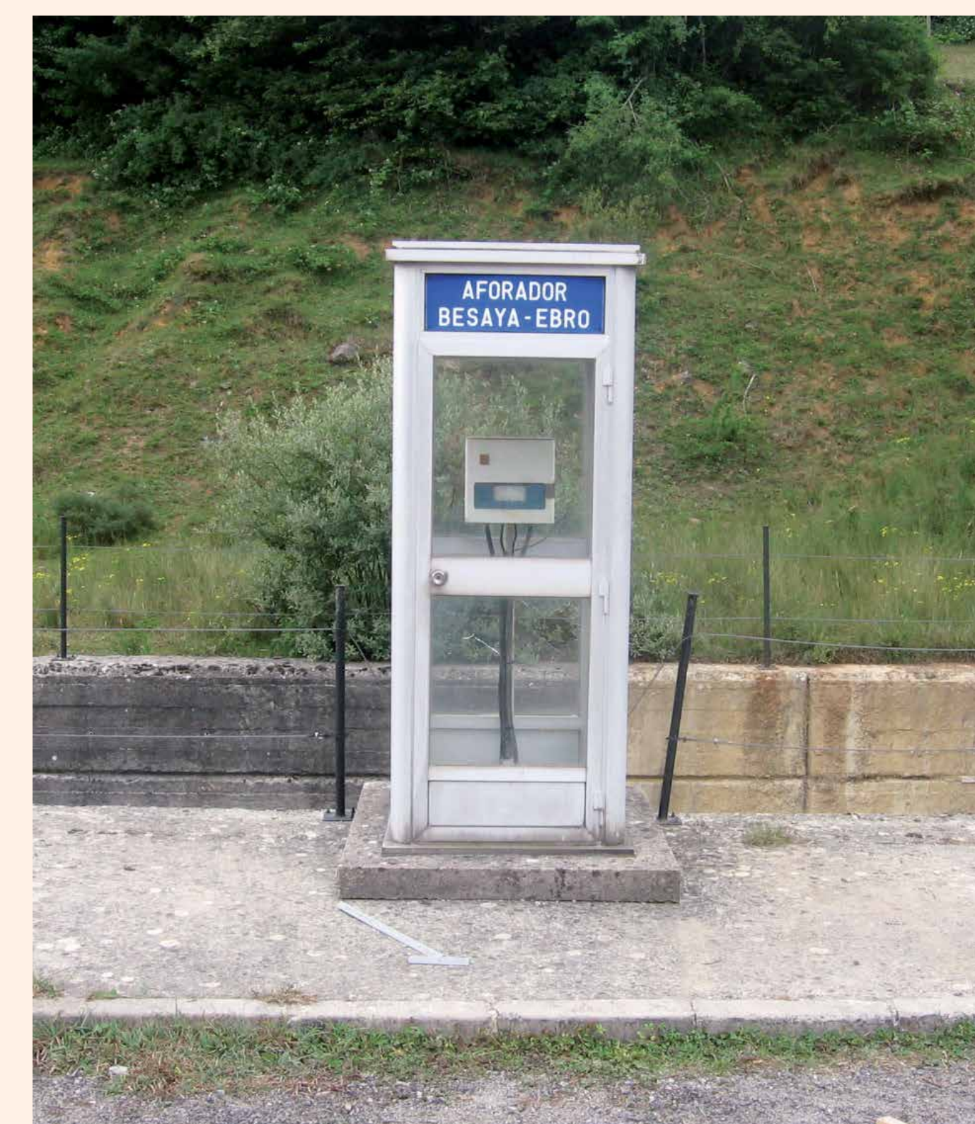
Punto de aforo a la entrada del túnel de las Nieves en trasvase hacia Cantabria
