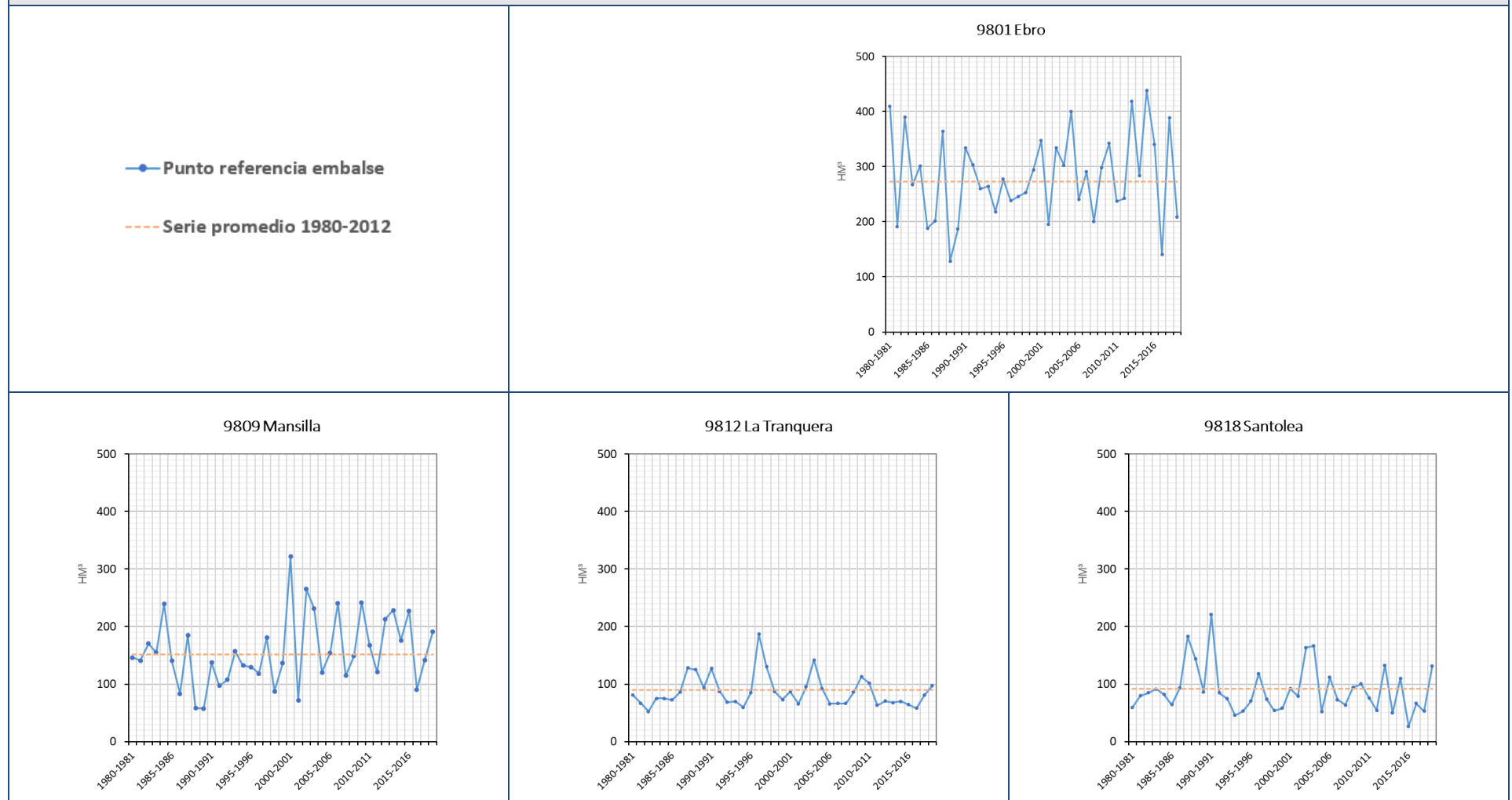
Figura 9. Aportaciones medidas en puntos de referencia que pueden considerarse próximos al régimen natural (hm 3 /año). Cabecera (9801 Ebro) y margen derecha del Ebro (9809 Mansilla; 9812 La Tranquera; y 9818 Santolea)
